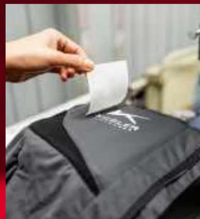
Transfers oder Patchabzeichen sind übertragbare Drucke und Applikationen, die mittels einer Wärmepresse schnell und exakt auf Textilien aufgebracht werden können. Die ausgezeichnete Druckqualität entspricht den hohen Anforderungen von Handel und Industrie.
